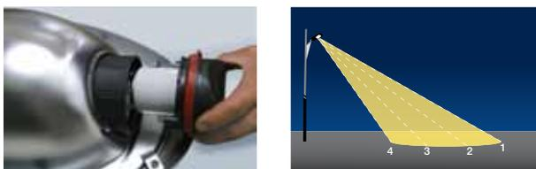
Permite ampliar o disminuir la curva fotométrica frontalmente. Cuenta con 4 posiciones y se modifica cambiando el portalámparas de altura de la regleta horizontal de sujeción.
